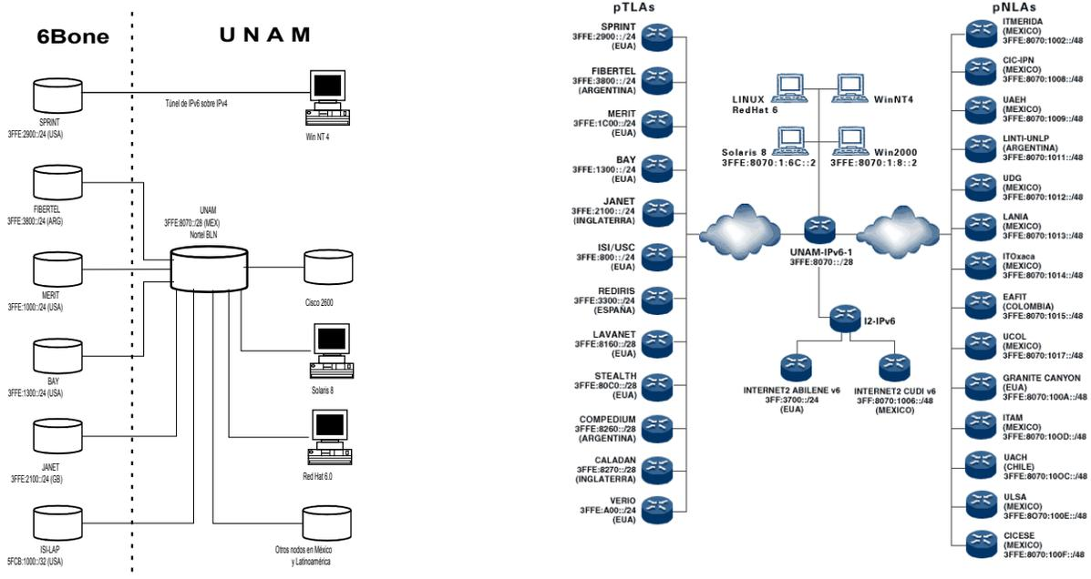
**Figuras 6 y 7. RedUNAM IPv6 versiones 1 y 2.**
